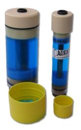
L'électrode de référence se compose d'une douille *CEI* **1010** reliée à une barre de cuivre, celle-ci baigne dans du sulfate de cuivre (Cu/CuSO4).
