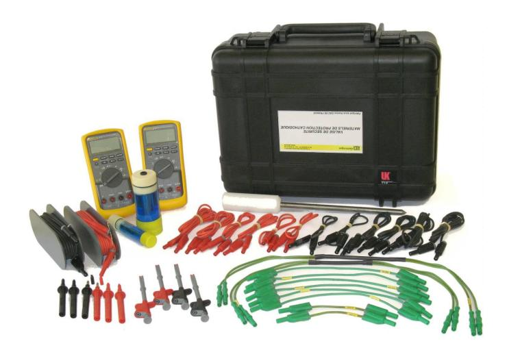
La société ADCA et le département d'expertise du pôle technique de GRTgaz ont mis au point un ensemble de matériel permettant d'effectuer des mesures classiques de protection cathodique à mains nues et en toute sécurité.
