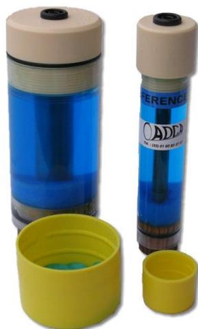
L'électrode de référence se compose d'une douille **CEI 1010** reliée à une barre de cuivre, celle-ci baigne dans du sulfate de cuivre (Cu/CuSO<sub>4</sub>).
